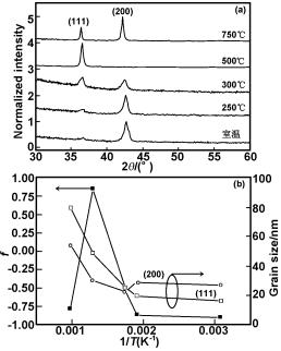
图 1 不同温度沉积的 N 掺杂  $Cu_2O$  薄膜的 XRD 谱和薄膜的晶粒取向因子 f 以及晶粒尺寸随沉积温度的变化
