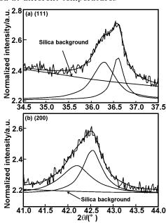
图 3 300℃下沉积的 N 掺杂 Cu<sub>2</sub>O 薄膜的衍射峰分峰结果
